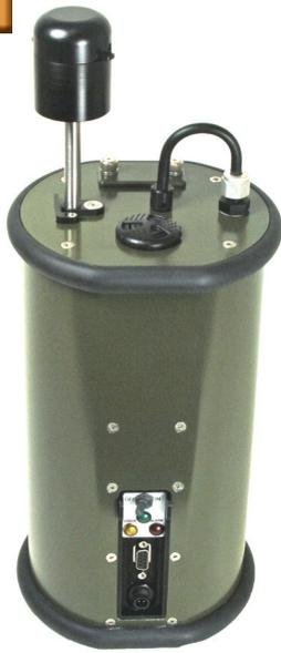
TacBio は、軍隊、国土安全保障、公衆衛生などのアプリケーションのために米国政府によって開発されました。空気中のエアロゾルをモニタリングして、生物学剤の可能性の有無を分類するために回折散乱と自然の生物学的蛍光を使用したコンパクトで堅牢な携帯用生物剤市エアロゾル検知器です。TacBio は、大気中の生物物質および非生物物質のバックグラウンドレベルを追跡してエアロゾルの急速な増加があるかどうかをアラームもしくは他の機器に出力する事ができる非常に有用なシステムです。生物物質の識別を行うことはできませんが、エアロゾルの‘トリガー’として正確に特徴付けることが可能です。
